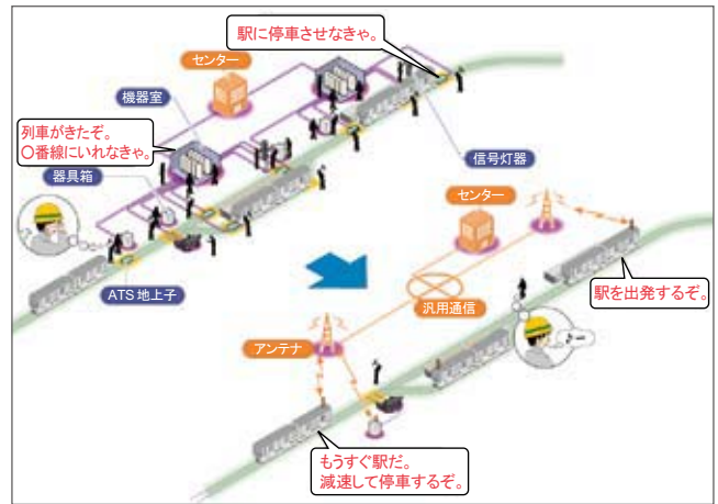
図9 地方・ローカル線・路面電車に有効な、地上システムが省略可能な運転管理システムの技術開発
