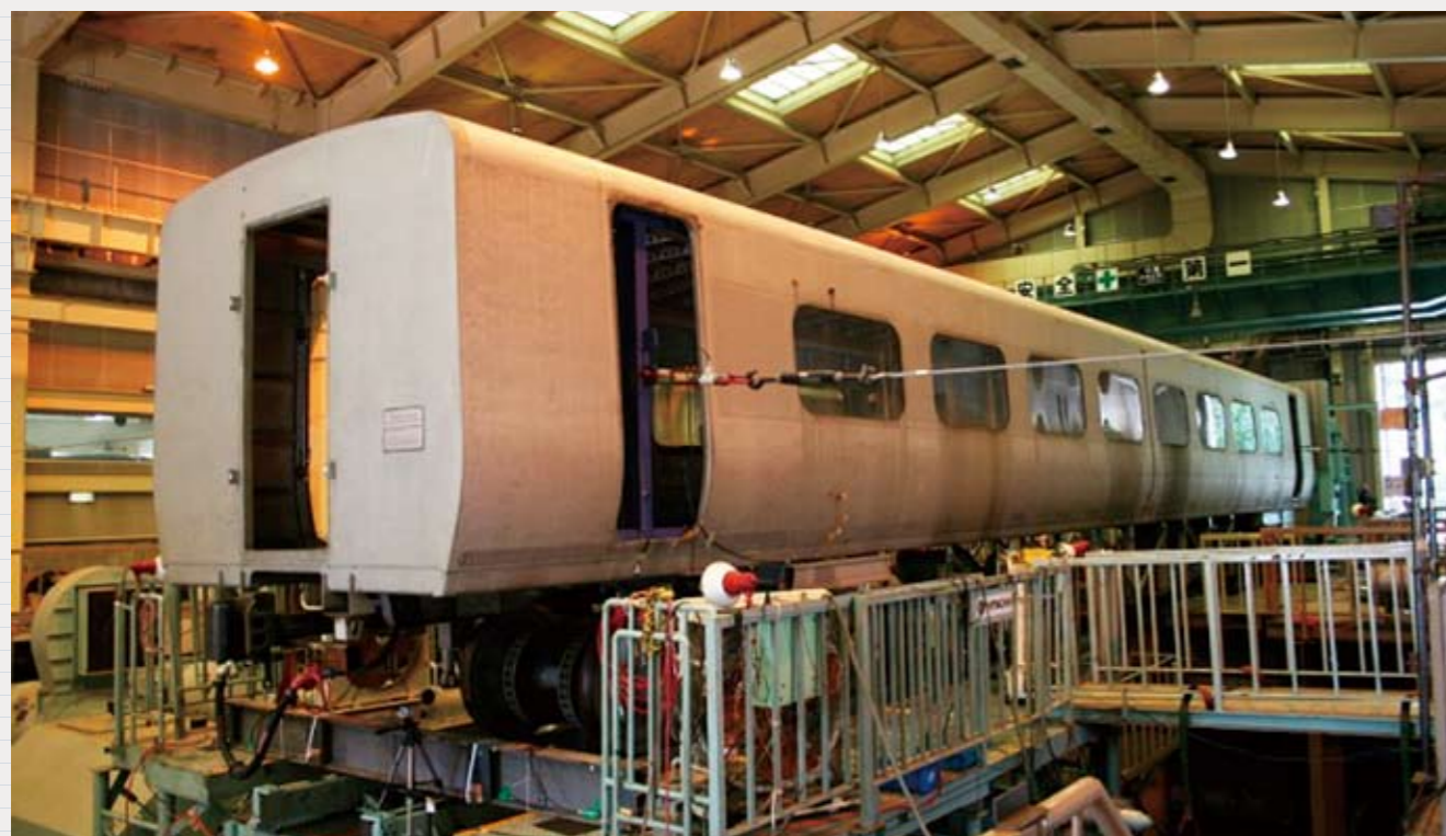
車体に働く空気力の変動による輪重減少率を推定するモデルを検証するため、実車に横力を負荷して、バネの変位や輪重などを測定しています。
