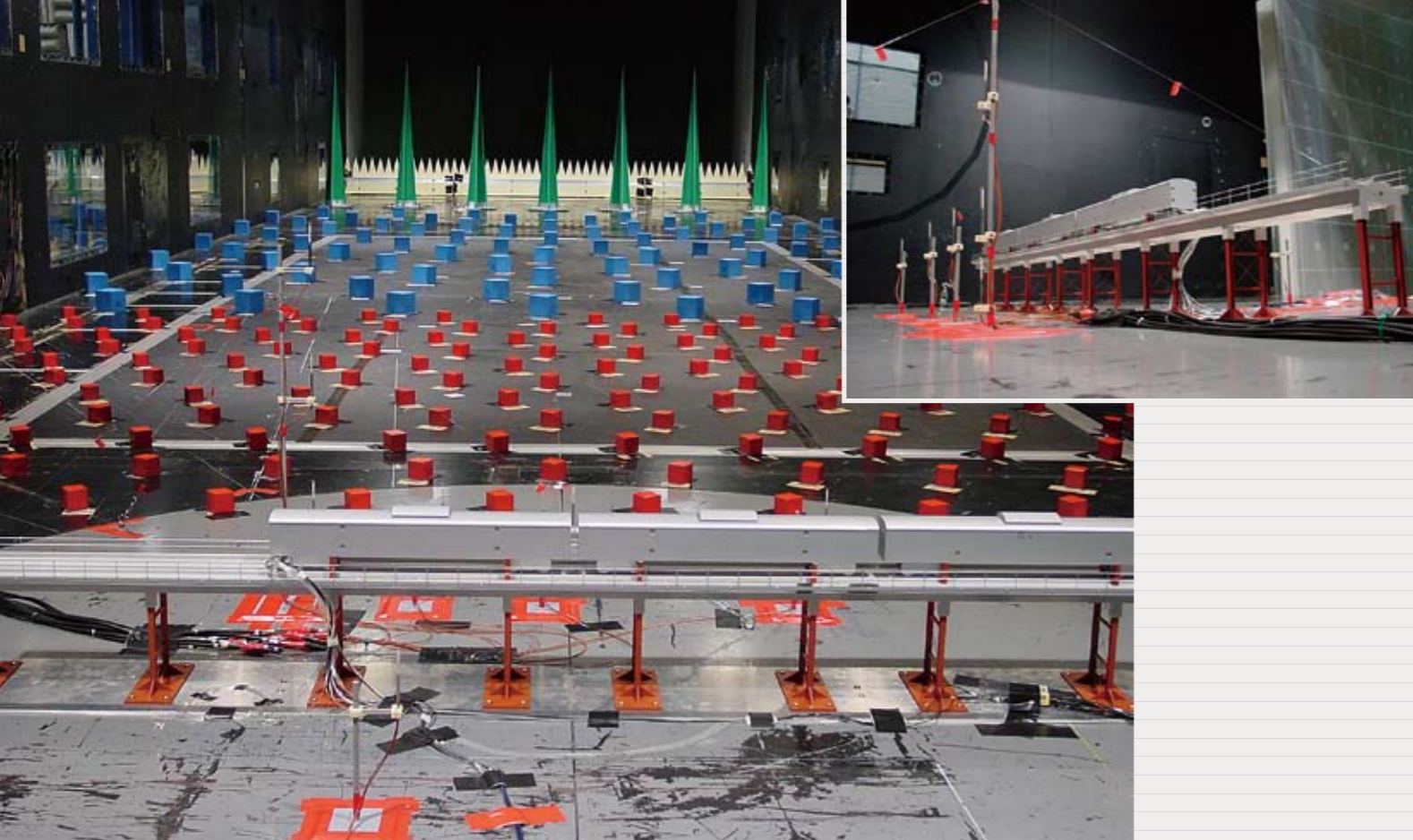
床面に凹凸を取り付けて自然風の特徴を再現した気流を作り、風速と空気力との関係を調べています。北海道の試験地で得られた風速と空気力の関係が、縮尺模型を用いた風洞試験で再現されていることを確認しました。
