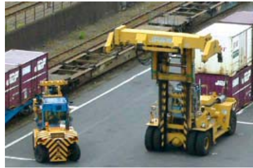
図3 荷役ホームでの積み卸し作業 (左:フォークリフト, 右:トップリフタ)
