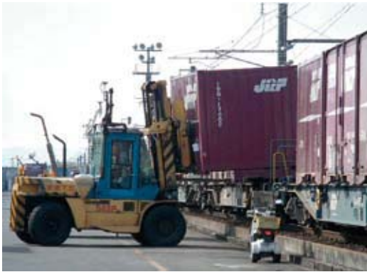
図4 E&S荷役方式駅 (線路上空に架線が張ってある)
