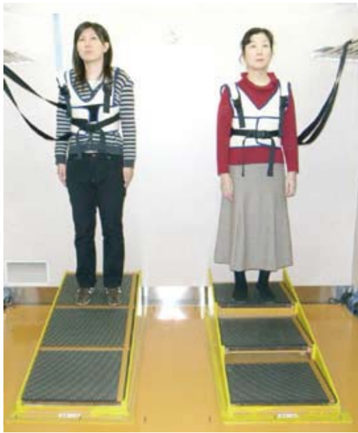
図8 勾配が同じオートスロープ(左)とエスカレーター(右)のモックアップ試験
