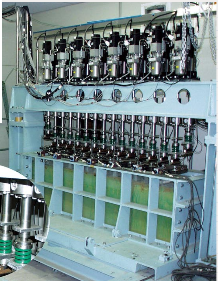
総合路盤試験装置はアクチュエーターが2基ですが，このマルチアクチュエーター方式小型移動載荷試験装置は，実物の1/5縮尺の模型軌道を対象として，16基のアクチュエーターをリアルタイムで制御し，左上の図にあるように，実際の列車荷重に相当する複雑な移動荷重を再現することができます。
