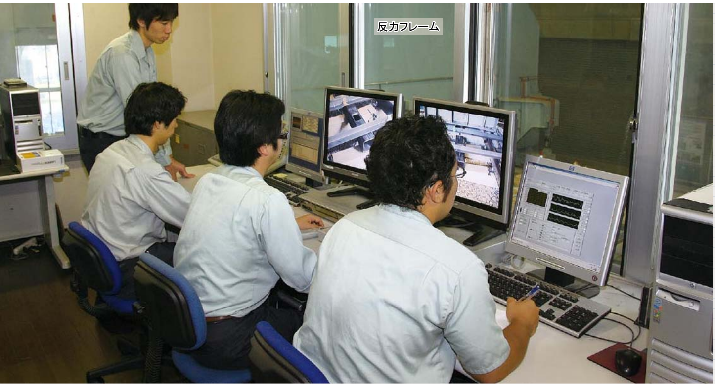
試験機に隣接した制御室の様子です。試験機の制御や計測，データの記録はコンピュータにより行っています。写真中央窓奥に見える反カフレーム下にある軌道の状態をカメラによって観察することができます。
