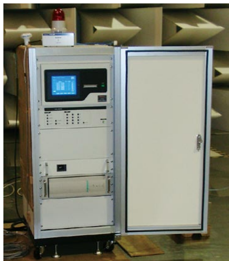
図1 地震計システム （上：制御用地震計，下：表示用地震計）
