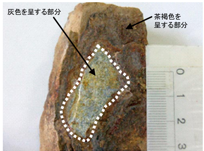
図5 破壊面の状況 (砂岩の例)
