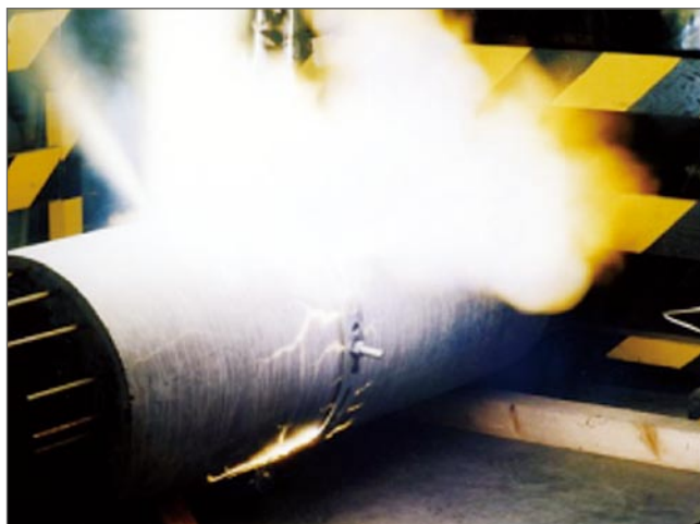
図3 コンクリート電柱絶縁破壊試験
