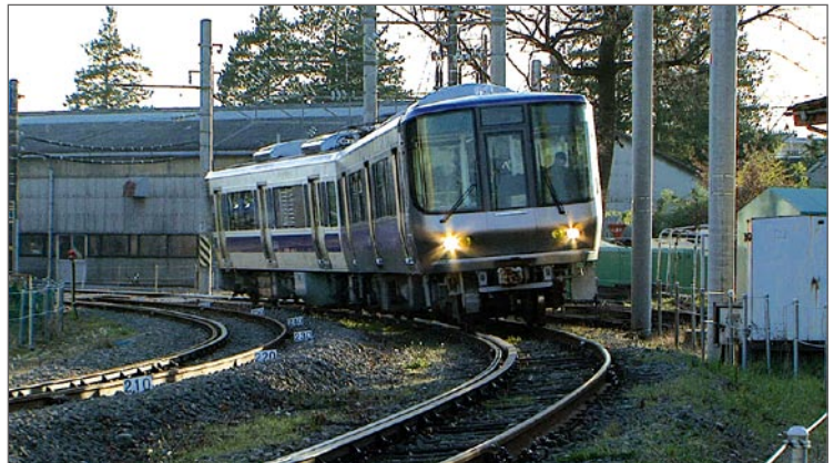
図2 燃料電池・バッテリーハイブリッド試験電車の走行試験状況
