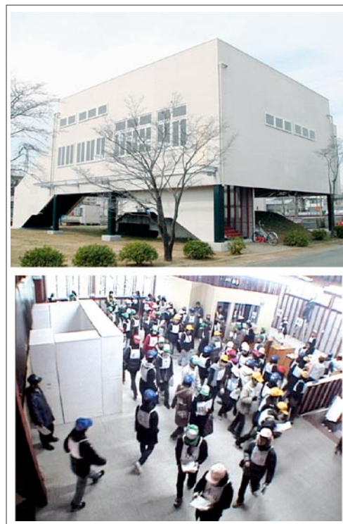
図6 駅シミュレータ外観(上)と旅客流動評価試験の様子(下)
