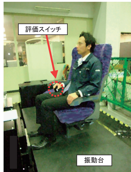
図2 振動台上の座席に着座した被験者
