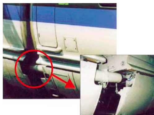
図5 新幹線電車に装備された車体間ヨーダンパ
