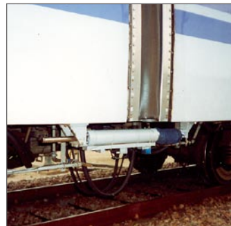
図2 車体間に取り付けた両ロッドダンパ
