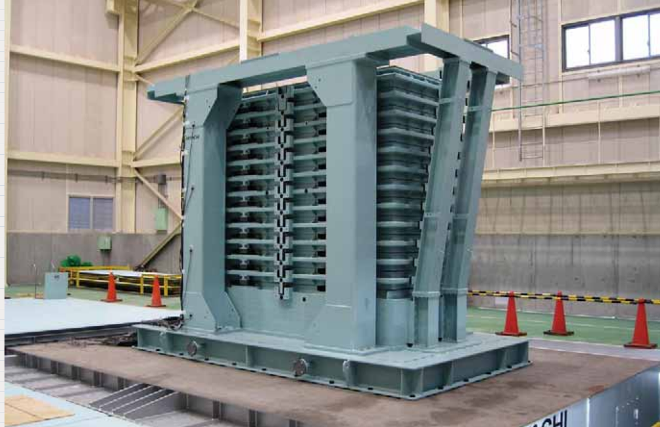
振動台を用いて地盤の実験を行うことも可能です。写真は「せん断土槽」という特殊な土槽を用いて地盤とその中に埋め込まれた杭基礎の振動実験中の写真です。兵庫県南部地震でも話題になった液状化現状の解明とその対策に貢献しています。
