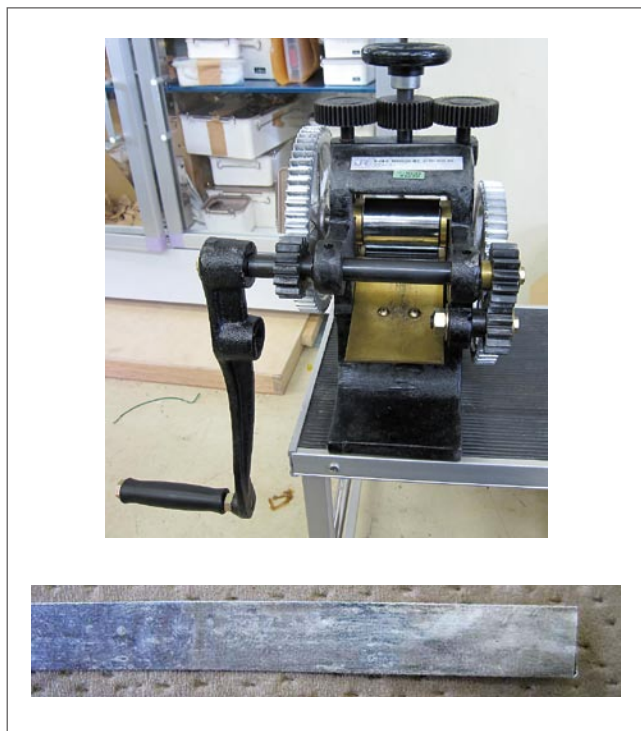
図3 Bi系超電導線材製作用の一次圧延装置(上)と圧延後の線材(下)
