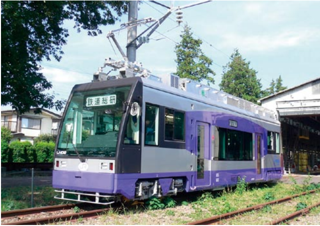
図3 リチウムイオン二次電池搭載試験電車
