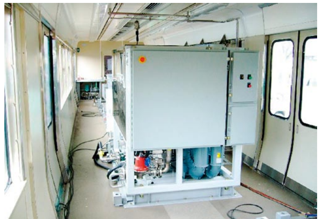
図6 開発した燃料電池と車両搭載状況
