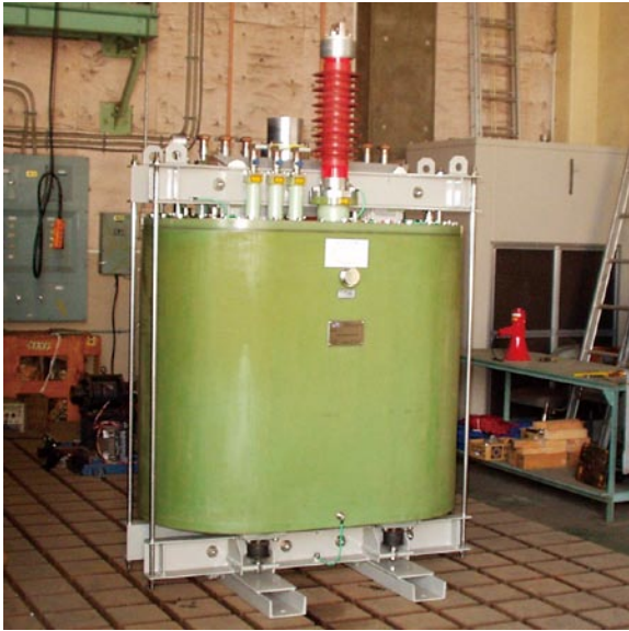
図10 試作した超電導主変圧器
