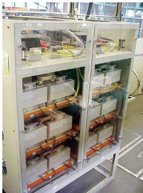
図2 開発した車載用大容量リチウムイオン二次電池
