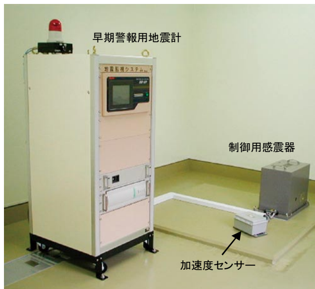
図8 早期警報用地震計の実用機
