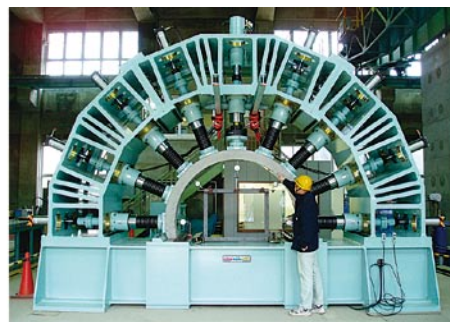
(b) 大型トンネル覆工模型実験装置 (縮尺 1/5)
