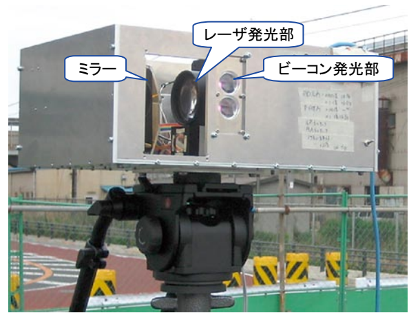
図3 通信装置の外観
