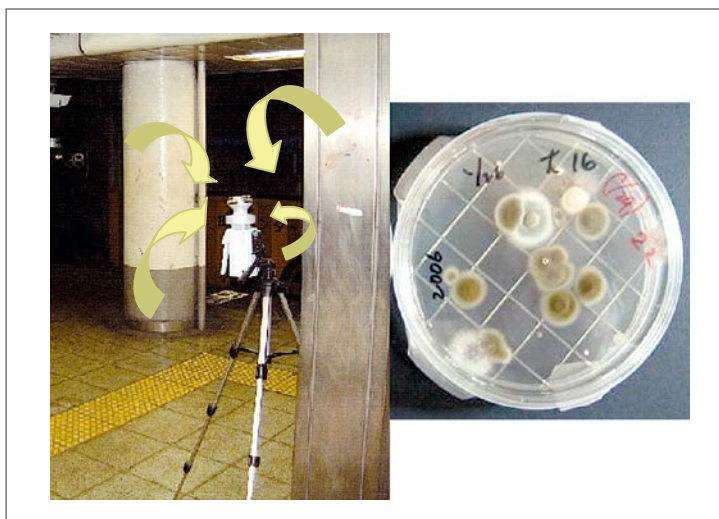
図2 空中浮遊微生物採取の様子(左)と出現したカビ(右)
