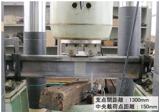
図11 曲げ疲労試験状況
