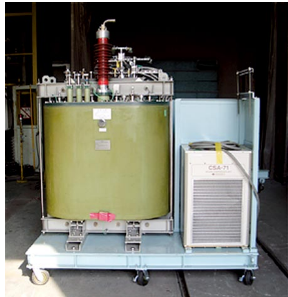
図 低交流損失超電導線による巻線および軽量、大容量な冷却システムを組み込んだ超電導主変圧器
