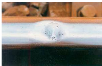
図1 レールに発生したシェリング
