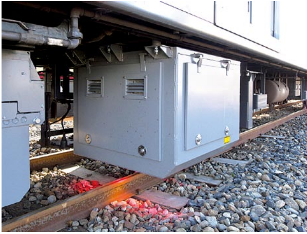
図9 軌道材料モニタリング装置
