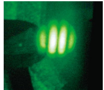
図4 ダイナミックホログラム結晶内で形成した干渉縞
