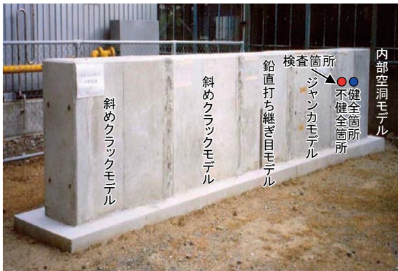
図6 欠陥を模擬した大型コンクリート供試体
