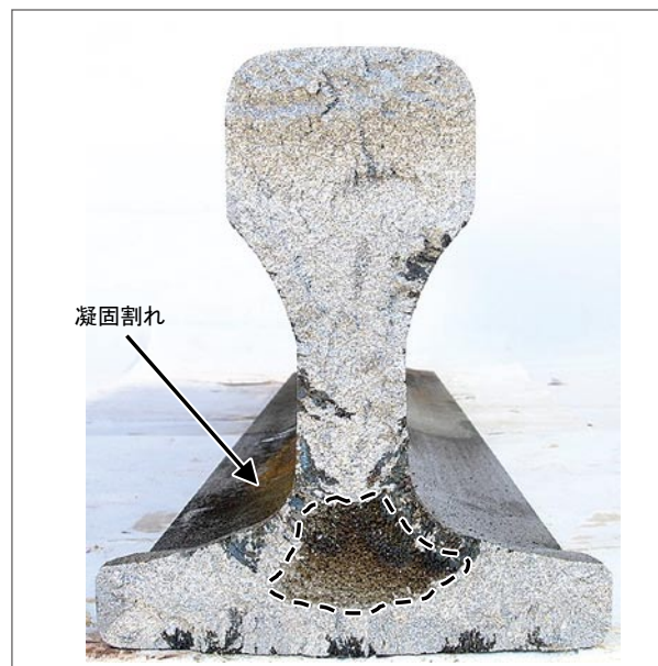
図 2 再現試験で発生させた凝固割れ破面例
