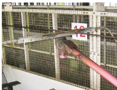
(a) すり板 2 列を間隔をあけず並べ 1 列 (低騒音型)・鉄系焼結合金
