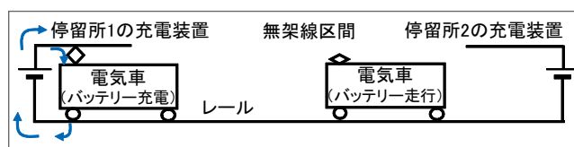
図11 架線・バッテリーハイブリッドLRVの構成例
