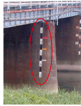
図5 水位観測用の量水標 図6 レールによる洗掘計
