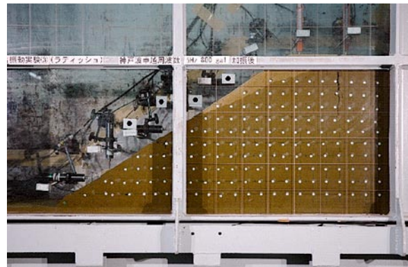
図 14 被災した盛土の状況(対策あり)
