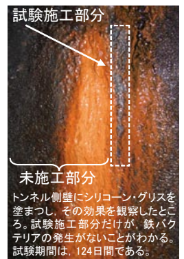
図1 鉄バクテリア抑制材料の効果
