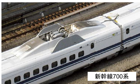
図1 TGVと新幹線の集電装置 新幹線には、パンタグラフに由来する騒音を低減するための種々の工夫が施されています
