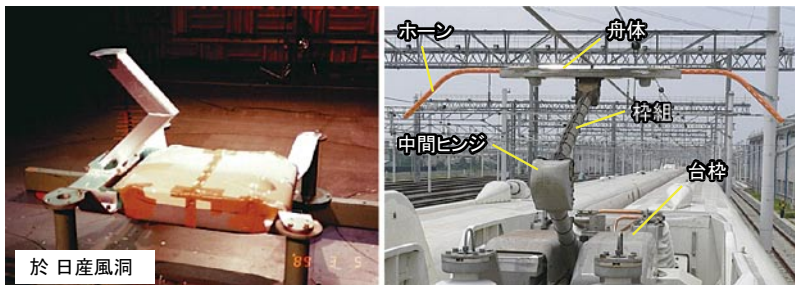
(a) シングルアームパンタグラフの基礎試験(1989年) (b) 700系用パンタグラフ 図6 低騒音パンタグラフ(シングルアームパンタグラフ)
