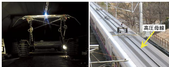
図2 離線アーク(左)とアーク音対策としての高圧母線(右)
