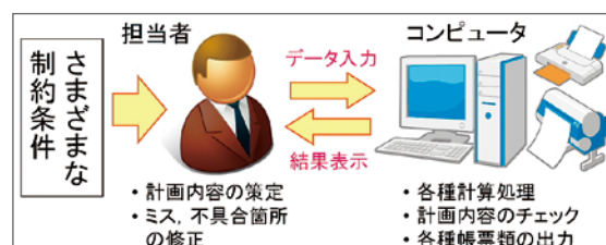
図1 マンマシンインタラクティブシステムの構成
