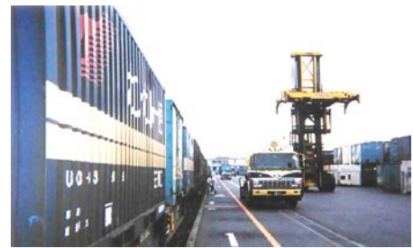
図3 駅で貨物列車とトラック間のコンテナ積換え
