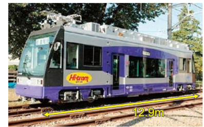
図5 架線・バッテリーハイブリッドLRV “Hi-tram(ハイ!トラム)”
