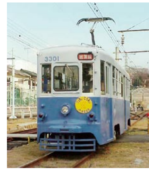
図4 架線・バッテリーハイブリッド路面電車“りっちい・とらみい”
