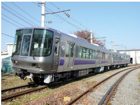
図1 R291系 燃料電池・バッテリーハイブリッド試験電車
