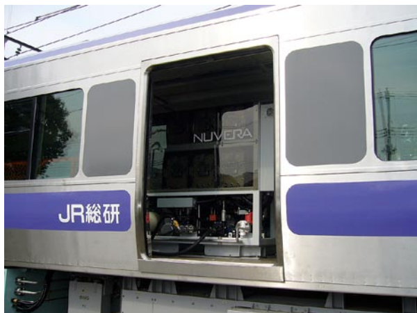
図2 100kW級燃料電池車両搭載状況
