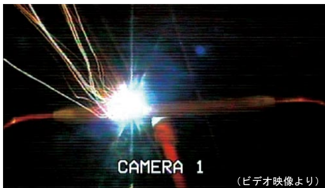
図2 離線時のアーク放電
