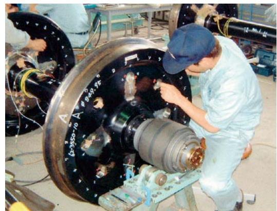
図4 輪重・横圧測定ひずみゲージ貼付け
