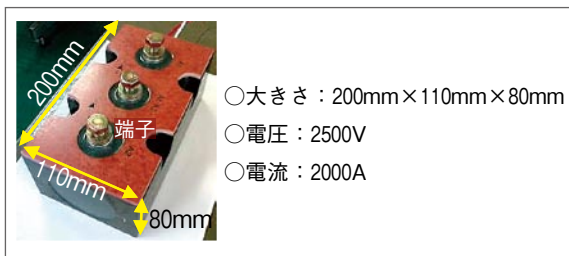
図3 試験に使用するパワー半導体素子
