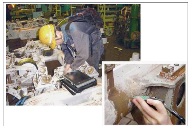
図12 ACFM台車枠検査装置の現場での検証試験
