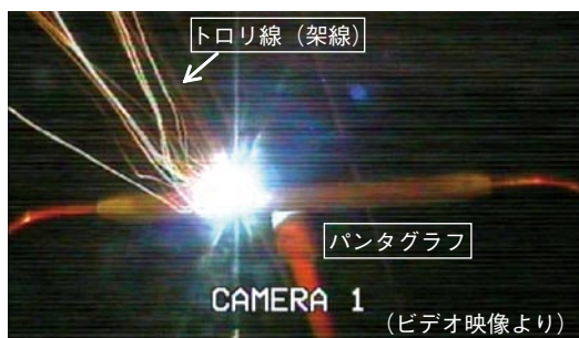
図1 離線時のアーク発生状況例
