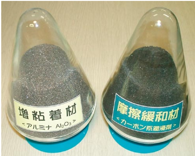
図8 増粘着材(左)と摩擦緩和材(右)
