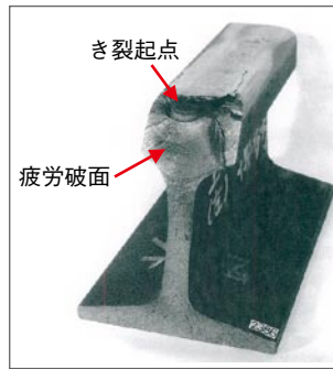
図11 レールシェリングの破断面の例
