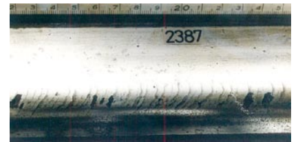
図12 きしみ割れの例
