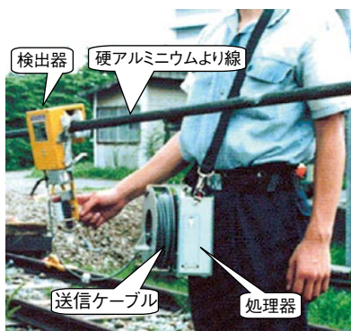
図1 硬アルミニウムより線用の腐食劣化判定装置
