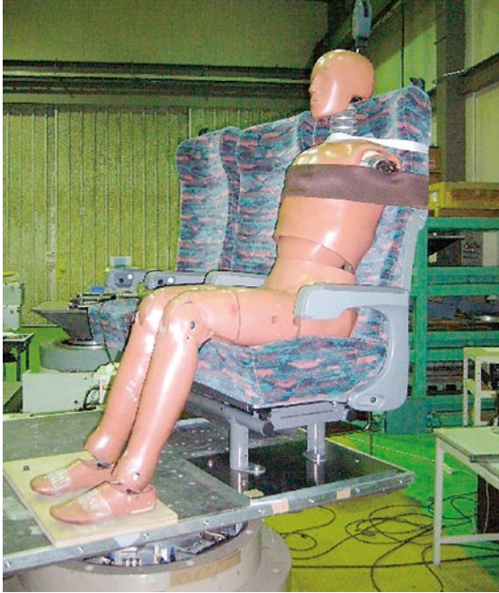
図3 振動台による測定風景
