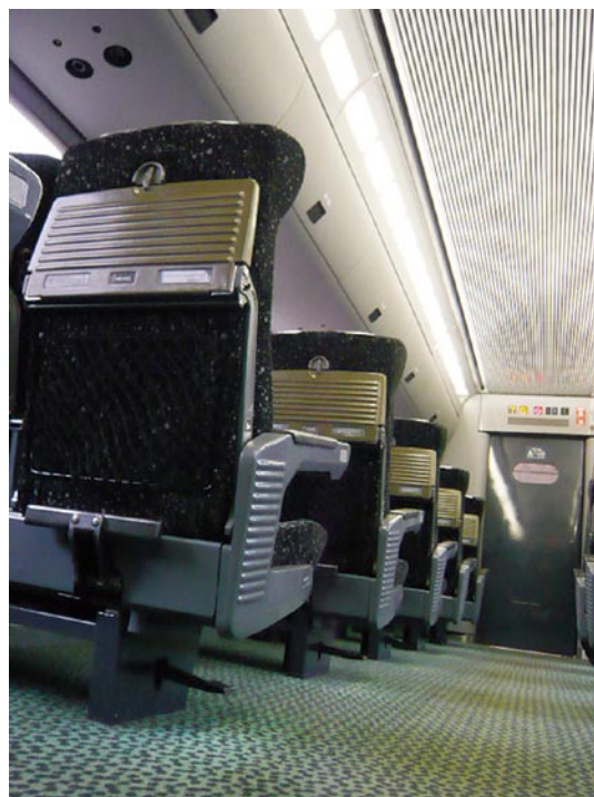
図2 787系 天井、腰掛、背面テーブルに統一されたライン
