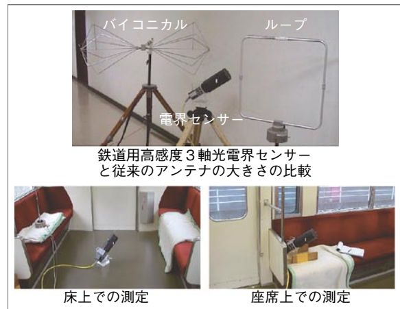
図11 鉄道用高感度3軸光電界センサーと従来のアンテナの比較
