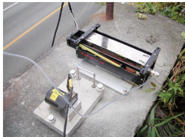
図7 擁壁上面に設置した小型起振器とセンサー
