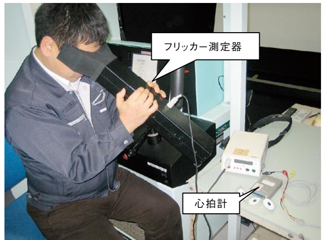
図2 フリッカー測定器と心拍計
