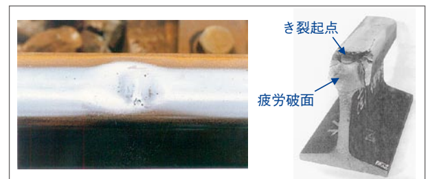
図8 シェリングの外観と破断面の例
