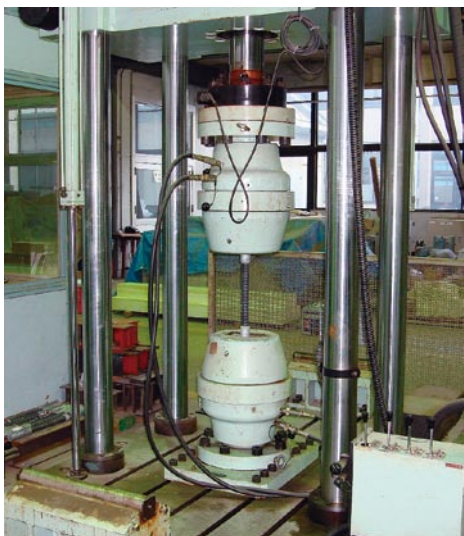
図8 鉄筋の疲労試験状況
