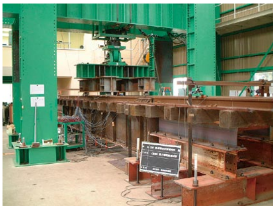
図6 桁試験体の疲労試験状況
